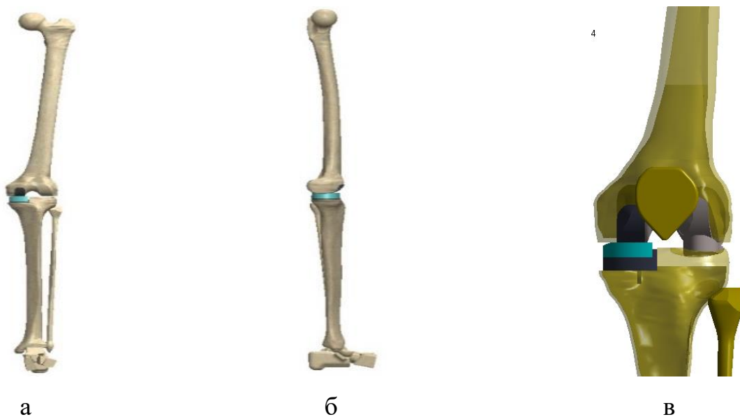
Рис. 2.1. Базова модель нижньої кінцівки з моноконділярним ендопротезом колінного суглоба, де: а) вид у фронтальній площині; б) вид в сагітальній площині; в) вид колінного суглоба.
