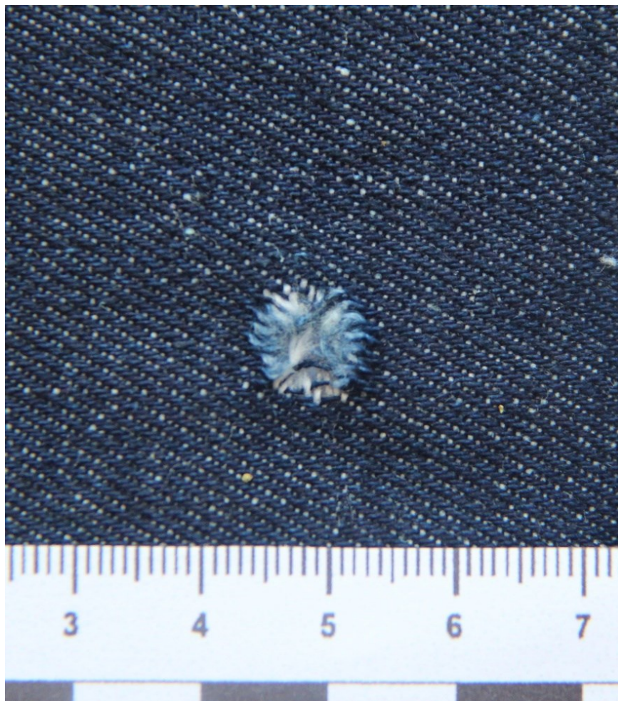
Рис. 5.1.5. Пошкодження джинсової тканини при пострілі з Форт 12Р з дистанції 25 см. \times 4,8
