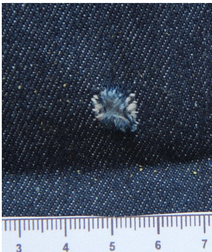
Рис. 5.1.14. Пошкодження джинсової тканини при пострілі з AE790G1 з відстані 25 см. \times 4,8
