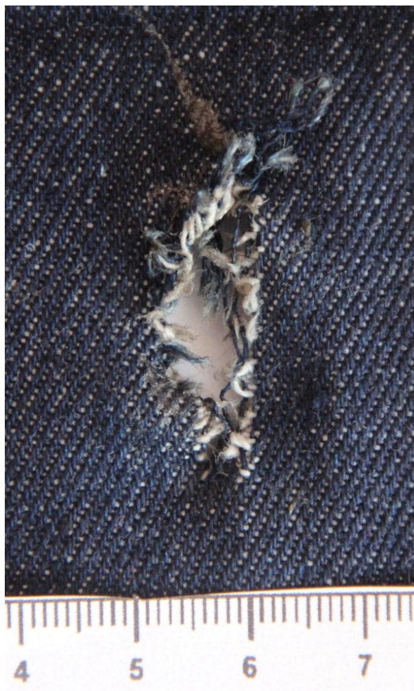
Рис. 5.1.4. Пошкодження джинсової тканини при пострілі впритул з Форт 12Р. \times 4,8
