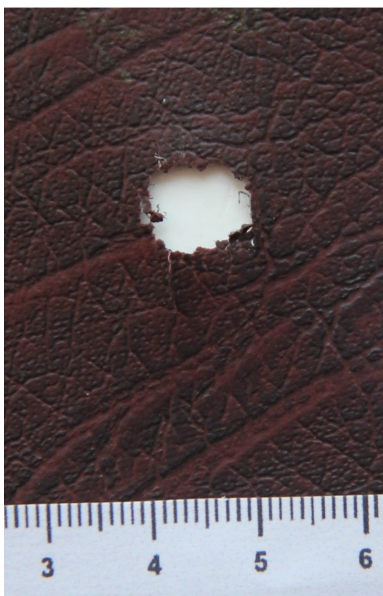
Рис. 5.1.9. Пошкодження шкірозамінника при пострілі з Форт 12Р з дистанції 50 см. \times 4,8
