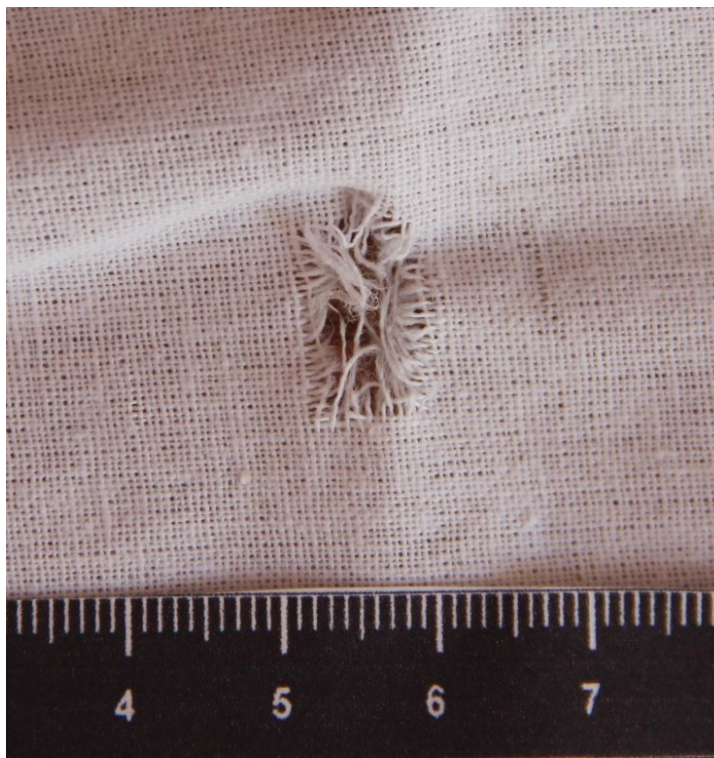
Рис. 5.1.3. Пошкодження бавовняної тканини при пострілі з Форт 12Р з дистанції 50 см. \times 4,8
