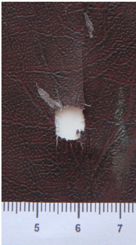
Рис. 5.1.8 Пошкодження шкірозамінника при пострілі з Форт 12Р з дистанції 25 см. \times 4,8
