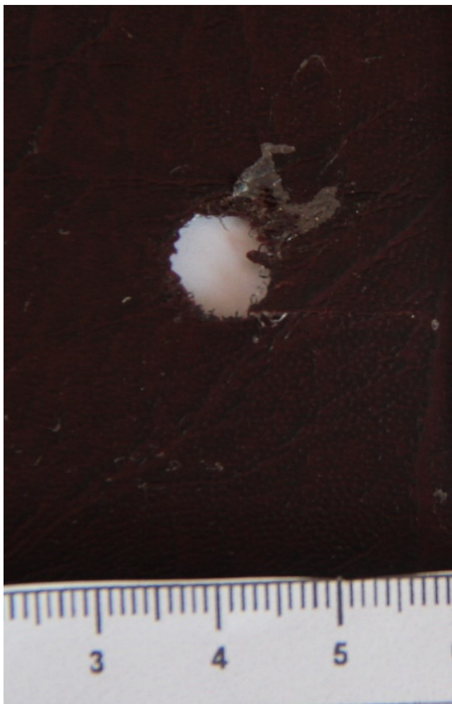
Рис. 5.1.18. Пошкодження шкірозамінника при пострілі з АЕ790G1 з відстані 50 см. \times 4,8
