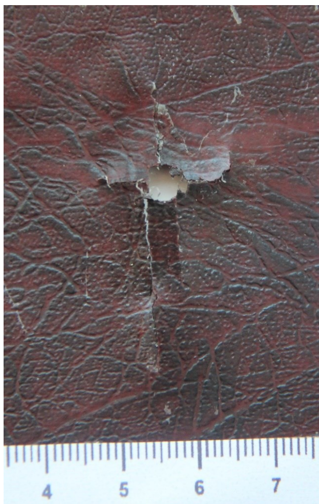
Рис. 5.1.7. Пошкодження шкірозамінника при пострілі впритул з Форт 12Р. ×4,8
