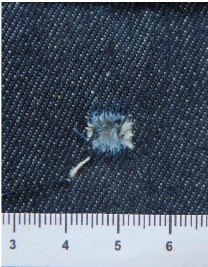
Рис. 5.1.6. Пошкодження джинсової тканини при пострілі з Форт 12Р з дистанції 50 см. \times 4,8
