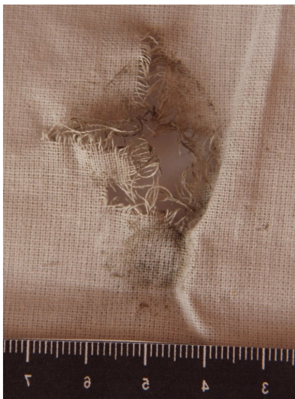
Рис. 5.1.10. Пошкодження бавовняної тканини при пострілі впритул з АЕ790G1. \times 4,8
