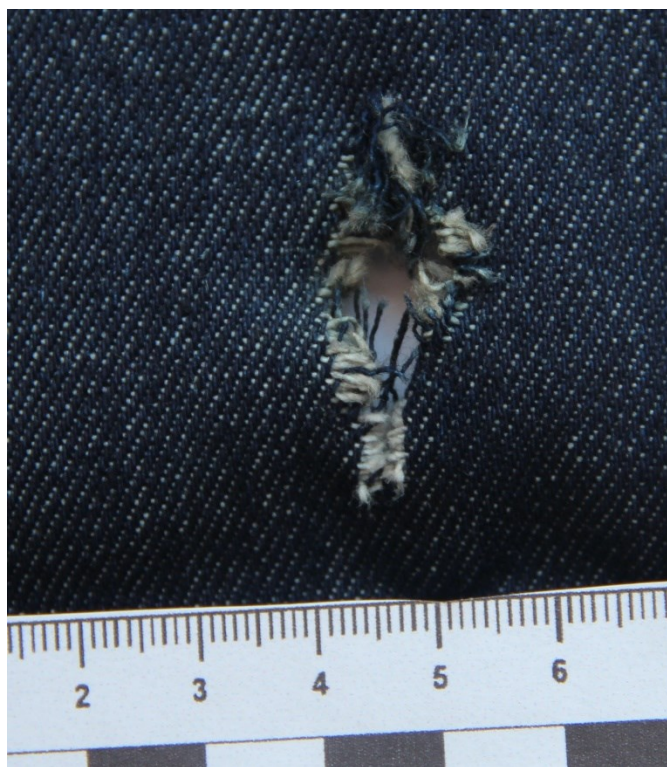
Рис. 5.1.13. Пошкодження джинсової тканини при пострілі впритул з АЕ790G1. \times 4,8
