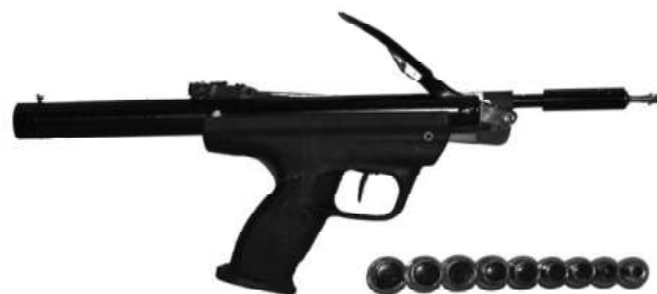
Рис. 1. Пружинний ударник для нанесення дозованої ТЧМТ у експериментальних тварин з комплектом насадок діаметром від 0,5 до 1,5 см.
