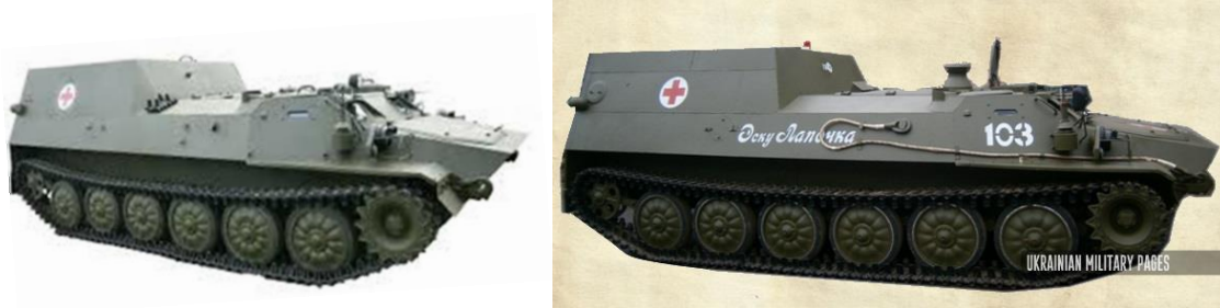
Мал. 3.3. Броньований транспортний засіб для вивозу поранених з поля бою “МТ-ЛБ”-С
