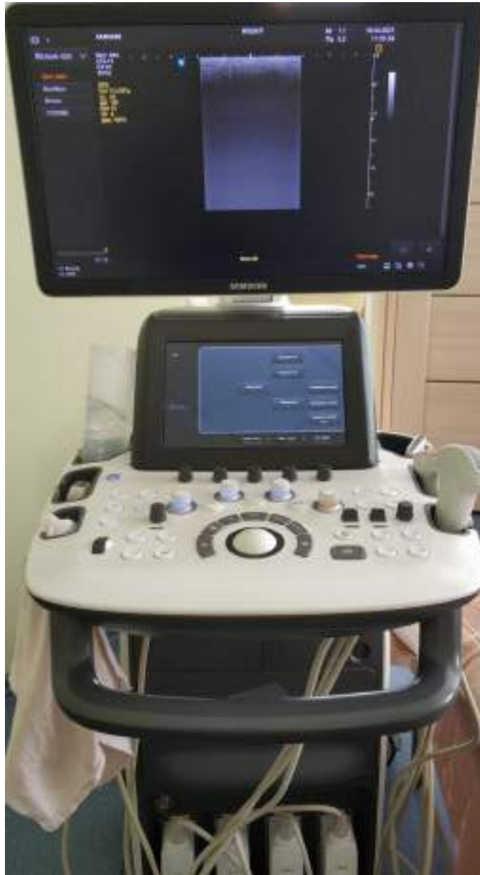
Рис. 2.12. УЗ апарат "SAMSUNG H60" (загальний вигляд).
