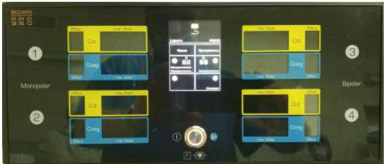
Рис. 2.2. Височастотний електрохірургічний апарат "BOWA-ARC 350", виробник "BOWA-electronic GmbH&Co." (загальний вигляд сенсорної панелі).
