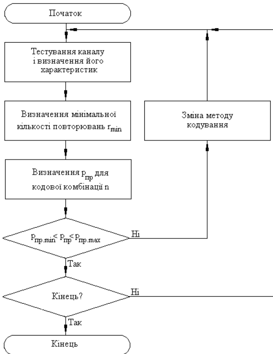
Рисунок 3.19 – Послідовність дій для вибору метода з повторюванням кодової комбінації за імовірністю її безпомилкового передавання
