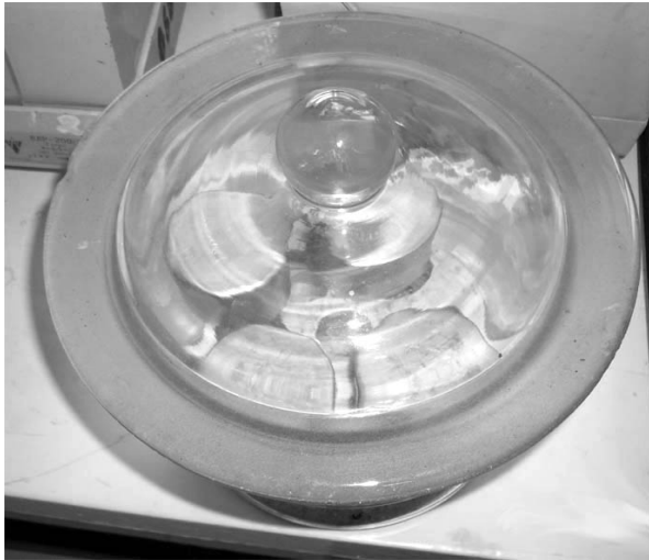
Рис. 3. Ексикатор, в якому приводиться температура бюкса до кімнатної температури
