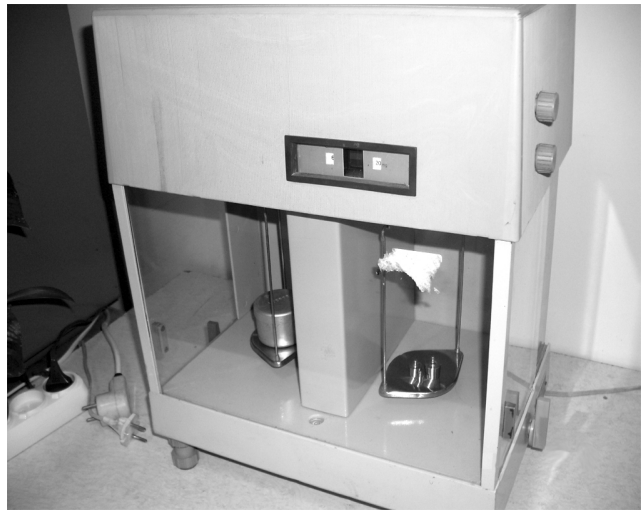
Рис. 4. Аналітичні ваги з точністю вимірів до 0,0001, за допомогою яких вимірюється маса бюкса з екстрагованою міцелою
