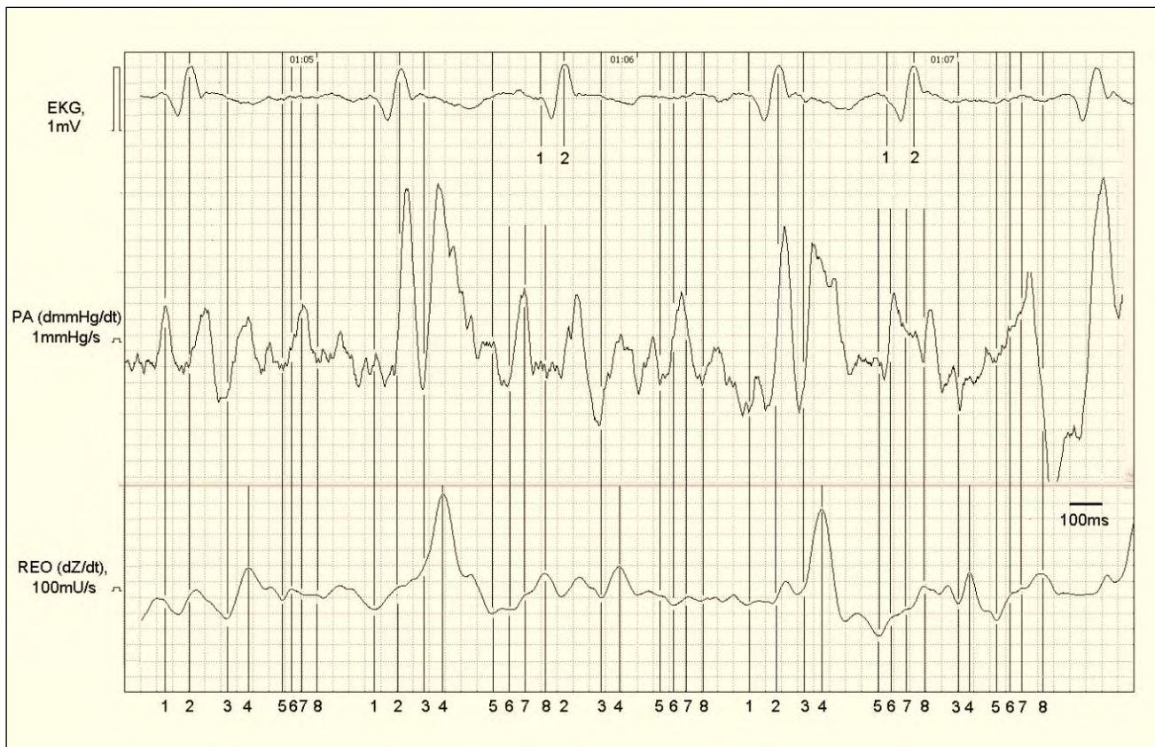
Рис. 25. Синхронная запись электрокардиограммы (ЕКГ), дифференциальной кривой (первой производной) давления в легочной артерии (РА) и грудной реограммы (РЕО). Собственные исследования.
