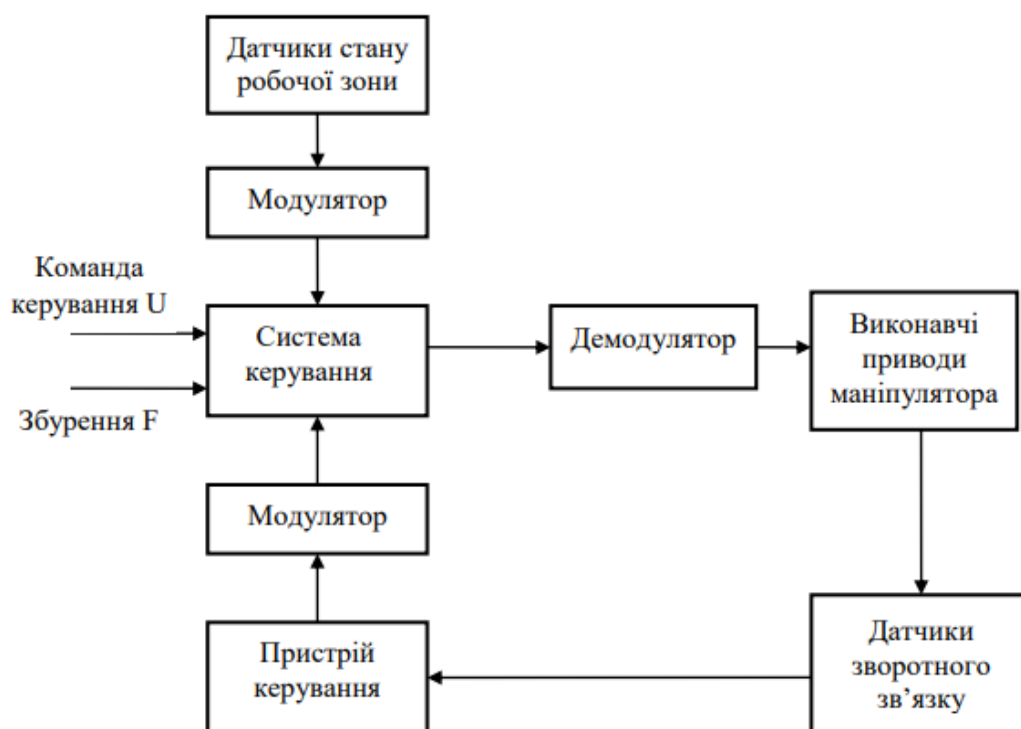
Рисунок 7 – Структурна схема інтерфейсу дистанційного керування антропоморфним маніпулятором Авторська розробка
