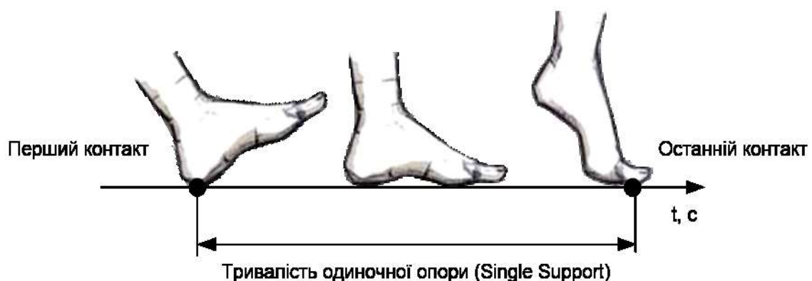
Рис. 5.13. Схема вимірювання тривалості опори на одну стопу (Single Support).
