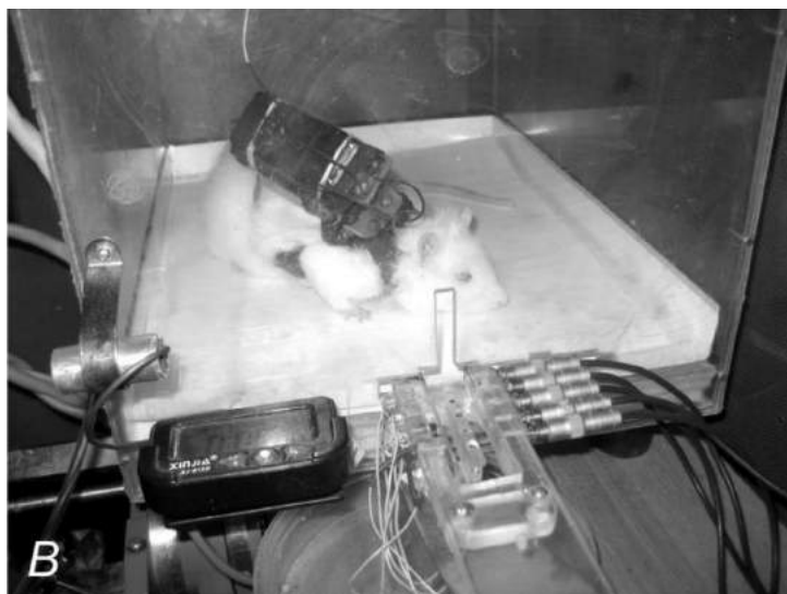
Тварина з передатчиком в експериментальній камері: на передньому плані – годівниця, з якої щур реалізує оперантний рух захоплення харчової кульки
