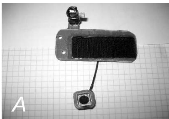
Мікрофон і платформа рюкзака для фіксації телеметричного передатчика
