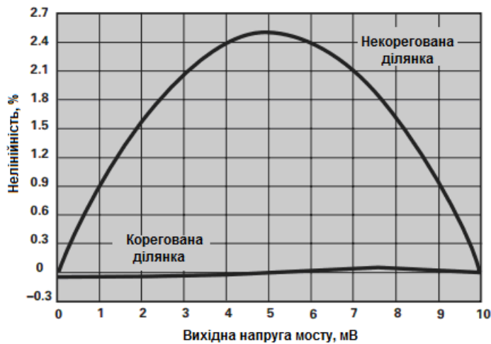
Рисунок 2.27 – Корегування нелінійності моста
