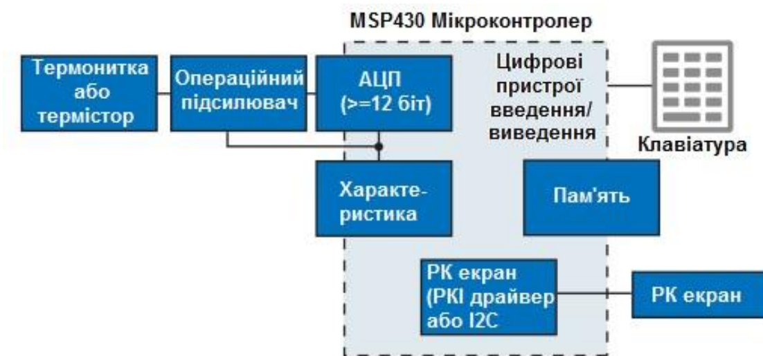
Рисунок 2.8 – Структура якісного цифрового термометра фірми Texas Instruments
