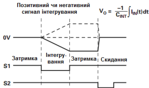
Рисунок 3.26 – Схема включення і часові діаграми роботи IVC102
