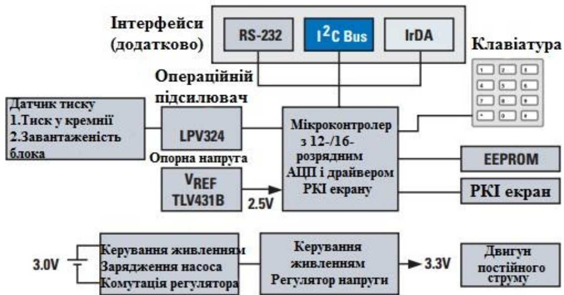
Рисунок 3.4 – Приклад застосування розширювача інтерфейсу I 2 C
