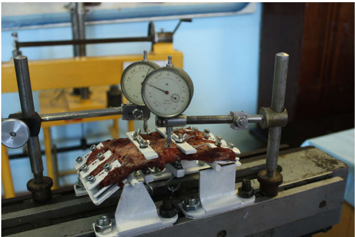
Рис. 5.26 – Випробування зразків після остеосинтезу спицями
