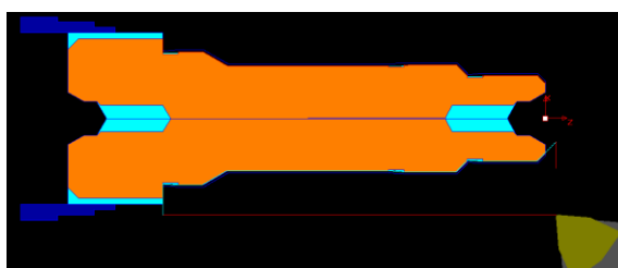
Рис. 6. Траєкторія руху інструменту при чистовій (контурній) обробці поверхонь
